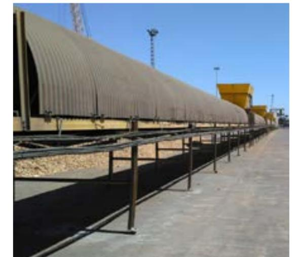
Ejemplo de instalaciones permanente de otro puerto similar, con Tolvas próximas a las zonas de las bodegas de los barcos y cintas transportadoras fijas.
