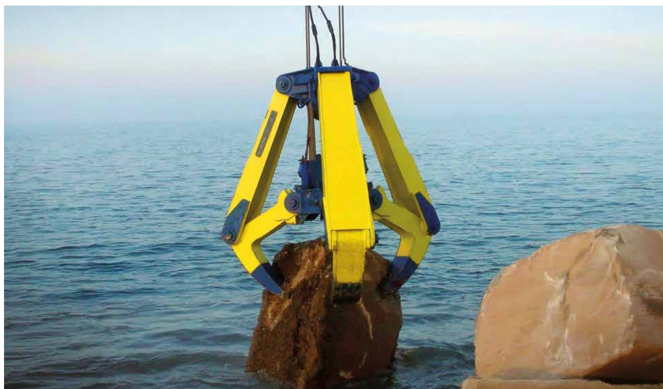
^ SATOGrab. Pinza para recuperación de bloques de 90 toneladas. España. SATOGrab. Clamp for the recovery of 90 ton blocks. Spain.
