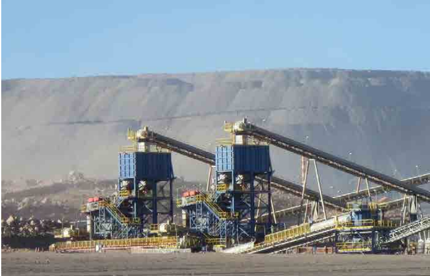
Sistema integral de trituración, transporte, curado ácido y apilado de óxidos de cobre para Codelco, División Ministro Hales. México. Integrated system of copper oxide crushing, conveyor, acid curing and stacking for Codelco Ministro Hales Division. Mexico.
